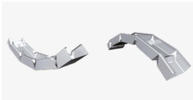
Montanti flessibili conformi alla Norma EN 13964; si dividono in **concavi** e **convessi**. Tali permettono la realizzazione di controsoffitti curvi, volte a botte, crociera, ecc. Sono **autobloccanti** e **flessibili**: mantengono la loro curvatura una volta piegati e possono essere adattati con estrema facilità a tutte le forme ricercate. Il senso della
