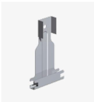
Foro passante diametro 5 mm. Conforme alla Norma EN 13964 viene utilizzato nelle controsoffittature curve per la sospensione della struttura primaria con profili a C 15/48/15 e C 27/48/27 a bordo arrotondato.
