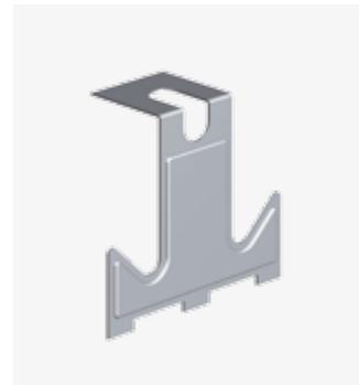
Conforme alla Norma EN 13964 viene utilizzato nelle controsoffittature curve serve da aggancio e blocco fra la prima e la seconda orditura a C 27/60/27.
