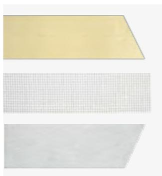
I nastri di armatura si dividono in 3 categorie: carta microforata, rete in fibra di vetro e feltro di vetro. Servono per armare il giunto tra lastre. Si consiglia l'utilizzo della carta microforata la quale permette di ottenere una tenuta maggiore ed una maggior precisione durante la curvatura.
