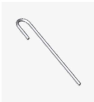
Conforme alla Norma EN 13964 viene utilizzato nelle controsoffittature curve come collegamento dei ganci con molla per profili alla soletta portante. Diametro tondino Ø 4 mm
