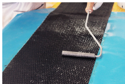
Phase 4: Homogenisierung des Imprägniermittels
