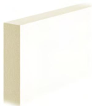
Bei der PIR-Wärmeplatte handelt es sich um eine Sandwichplatte, bestehend aus einem Dämmelement aus Polyisocyanurat-Hartschaum (PIR), der FCKW- bzw. HFCKW-frei aufgeschäumt wurde, beidseitig beschichtet mit gesättigtem Glasvlies, klassifiziert nach EN 13165. Ausgezeichnete Wärmeleitfähigkeit, die je nach Dämmplattendichte variabel ist.
