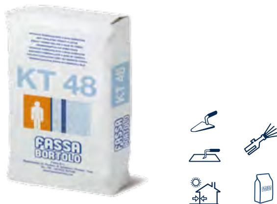
Wärmedämmputz nach EN UNI 998-1, eingestuft in die Klasse T-CSI-W1, auf Basis eines hydraulischen Bindemittels und Polystyrol-Zuschlagstoffen; kann von Hand und maschinell verarbeitet werden. Mindestauftragsdicke: 20 mm. Bietet eine ausgezeichnete Diffusionsfähigkeit und ist in vollem Umfang mit auch unregelmäßigem Mauerwerk aus Ziegeln, Betonblöcken, Rohbeton usw. kompatibel.
