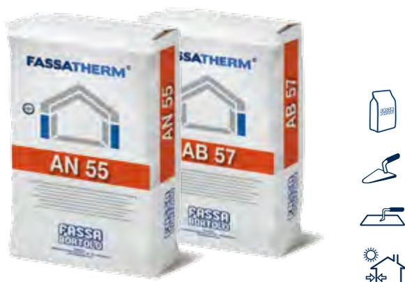
Werksgemischte Kleber auf Basis von Portlandzement, ausgesuchten Sanden und spezifischen Zuschlagstoffen für die bessere Verarbeitung und Haftung. Werden zum Kleben und Spachteln von EPS-Dämmplatten bei Wärmedämmverbundsystemen sowie für Armierungsspachtelungen mit geringer Schichtdicke verwendet.
