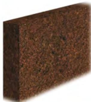
Die Wärmedämmplatte aus KORK ist nach EN 13170 klassifiziert und wird aus hochwertigem Backkork hergestellt. Die braune Farbe ist auf den sog. Backvorgang zurückzuführen, bei dem Korkpartikel durch heißen Wasserdampf expandiert werden. Dabei tritt das natürliche Harz Suberin aus dem Korkgranulat aus, wobei sich das Zellvolumen vergrößert. Dies sorgt für eine Verbesserung der Eigenschaften in Bezug auf die Wärmeleitfähigkeit, die Festigkeit und die Maßhaltigkeit.
