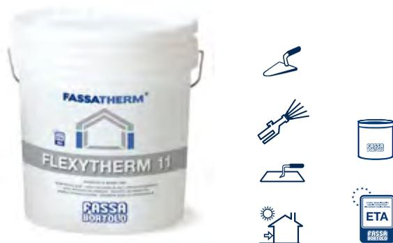
Faservergütete, zementfreie, pastöse Spachtelmasse mit hoher Elastizität, Korngröße < 1,2 mm. Erhältlich gebrauchsfertig verpackt. Wird als Armierspachtel auf EPS-Dämmplatten verwendet. Ermöglicht das Erzielen von Stoßfestigkeitswerten, die die eines herkömmlichen Wärmedämmverbundsystems um das 6-Fache überschreiten.
