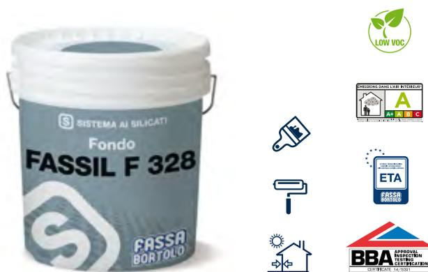
FASSIL F 328 ist eine wasserbasierte Grundierung auf Basis von Kaliwasserglas, die als Sperrgrund, Fixativ oder Verfestiger eines mineralischen Untergrunds vor dem Auftragen einer Endbeschichtung des Silikatsystems sowohl für Innen- als auch Außenbereiche verwendet wird.
