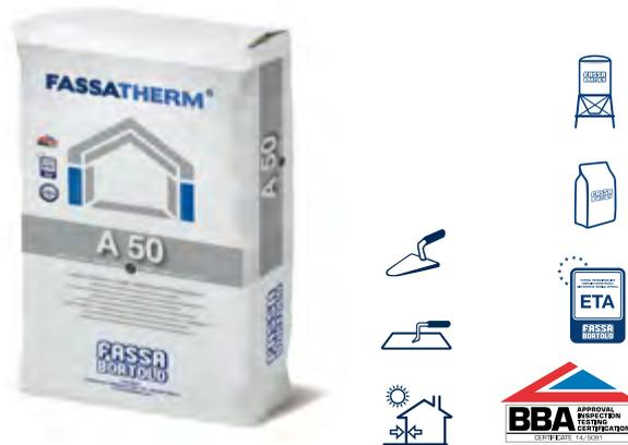
Faserverstärkter Zementspachtelkleber, Korngröße < 1,4 mm, entspricht den Vorgaben der Norm EN 998-1 und ist in die Klasse GP-CSIV-W2 eingestuft. Erhältlich in Säcken und Silos; kann auch maschinell aufgetragen werden. Wird zum Kleben und Spachteln von Dämmplatten aus EPS und Steinwolle verwendet. Lässt sich leicht verarbeiten und bietet ausgezeichnete Leistungen. Wird auch als Armierspachtel mit mittlerer Schichtdicke verwendet.
