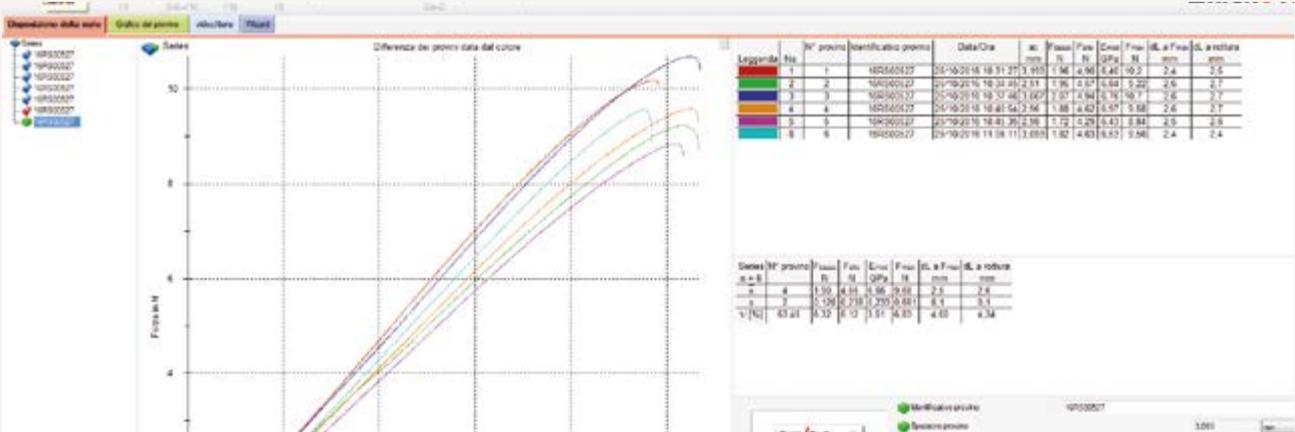
Am Ende der Prüfung werden Bruchlast in N und Verformung (Durchbiegung), bei der die Prüfkörper gebrochen sind, aufgezeichnet und somit die Verformbarkeitsklasse des Zementklebers definiert:
