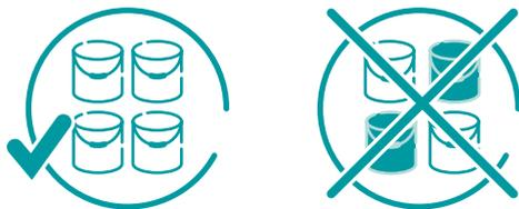
→ Das Material in einem einzigen Vorgang ausliefern und dabei möglichst versuchen, ein zeitversetztes und mit unterschiedlichen Chargen von Basisfarben durchgeführtes Einfärben zu vermeiden, um den Bau einheitlich abschließen zu können. Um das Phänomen "Farbtondrift" zu vermeiden, ist die Überprüfung des Farbtons immer bei der jeweils ersten Auslieferung durchzuführen.
