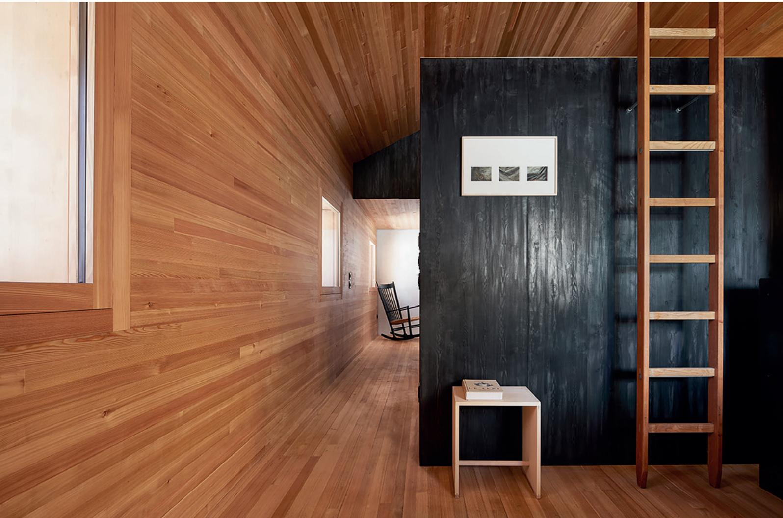
Le testate delle pareti interne sono state trattate con **ZM 136**, intonaco a base di gesso con finitura liscia.
