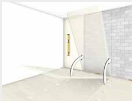
4. Posizionamento lastre sulla parete
