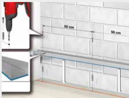
2. Posizionamento e fissaggio guida a pavimento
