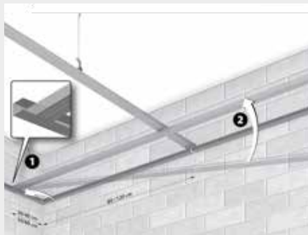
5. Inserimento profili primari nelle guide e successivo aggancio ai pendini
