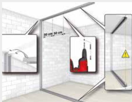
5. Posizionamento e fissaggio guida a soffitto
