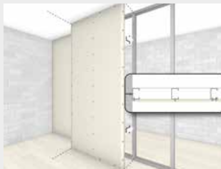
8. Posizionamento e avvitatura delle lastre successive
