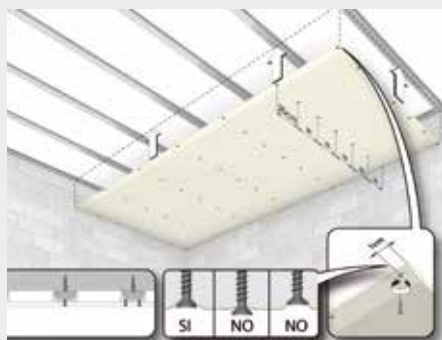
7. Avvitatura delle lastre
