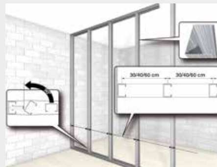
6. Inserimento e posizionamento dei montanti
