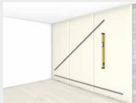
5. Allineamento delle lastre
