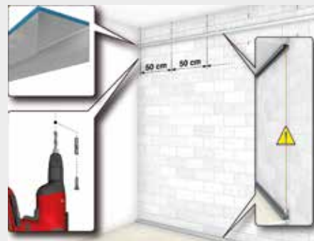
3. Posizionamento e fissaggio guida a soffitto
