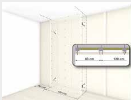
7. Posizionamento e avvitatura del primo strato e dell'eventuale secondo strato di lastre
