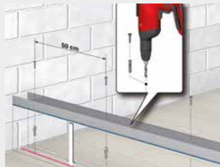
3. Posizionamento e fissaggio guida a pavimento
