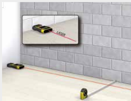
2. Tracciamento del limite esterno della controparete
