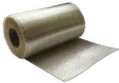
Tessuto unidirezionale, con grammatura 300 g/m<sup>2</sup>, costituito da fibre di vetro in ordito e da un filo di polimero termoplastico senza funzioni strutturali in trama.
