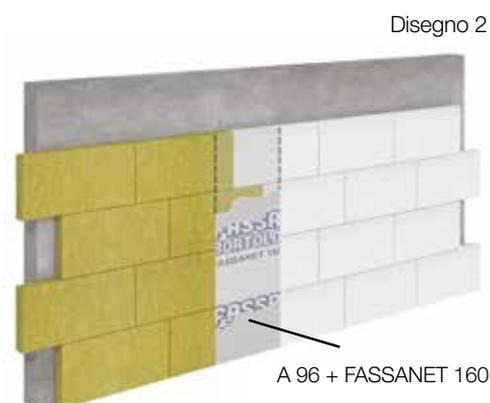
A seguire, su tutta la facciata (compresa la porzione rinforzata) verrà realizzata una rasatura armata integrale ed uniformante con rasante A 96 e rete d'armatura FASSANET 160 : su una prima mano di A 96, verrà posata ed annegata la rete Fassanet 160; a completamento del ciclo di rasatura armata, verrà applicata una seconda mano di A 96 a totale copertura della rete.
