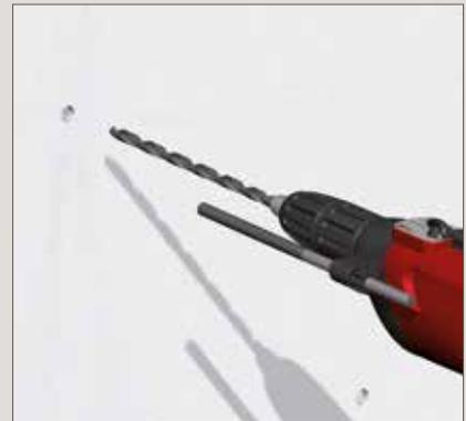
fresatura diametro 16-18 mm
