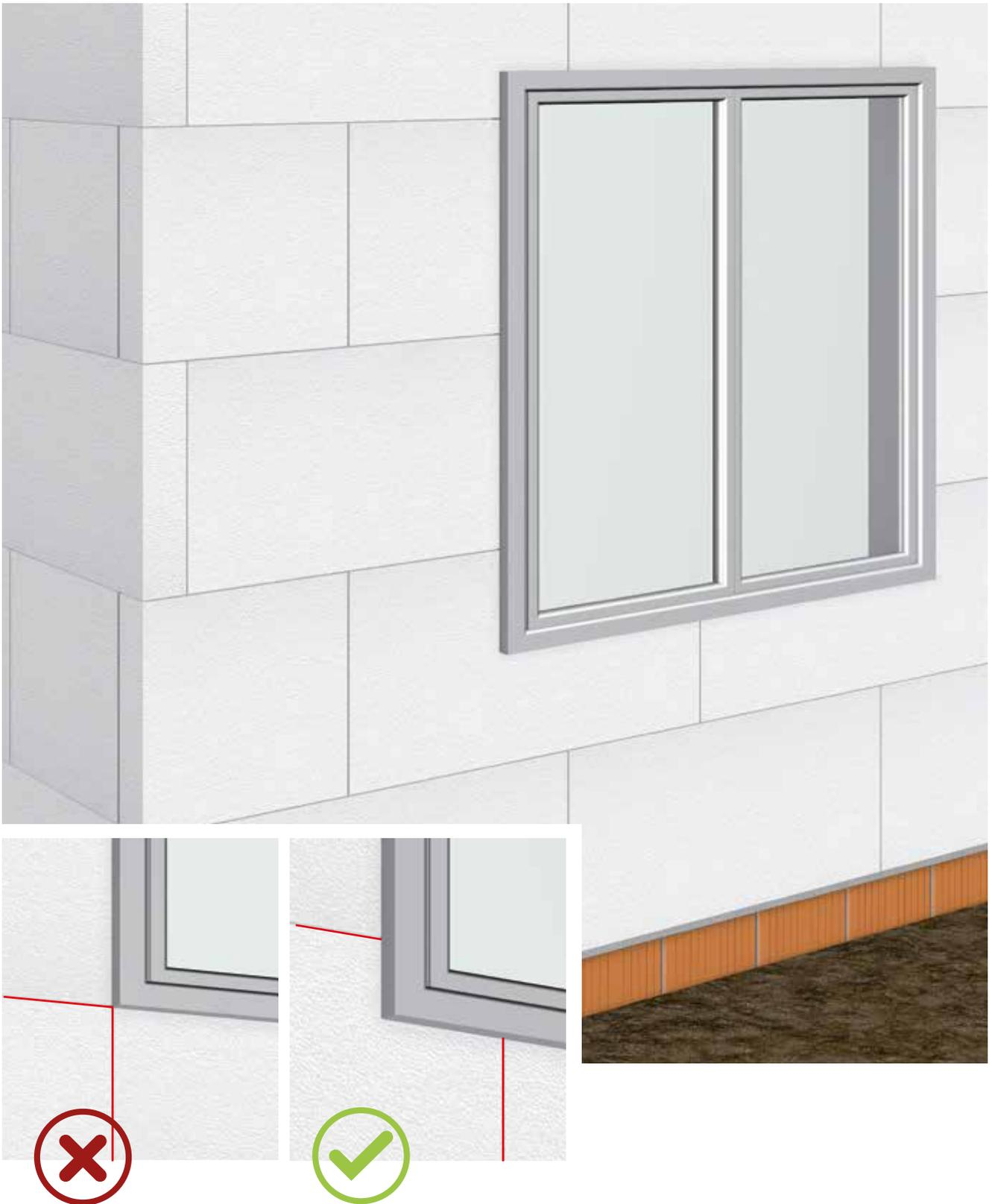
La posa delle lastre deve essere pianificata in maniera da prevedere che i giunti tra i pannelli siano sfalsati sia rispetto alle aperture di porte e finestre, sia rispetto alla presenza di discontinuità di materiali nel supporto.
