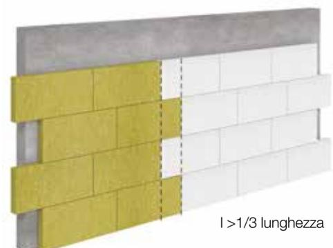
Sulla giunzione tra le lastre verrà applicato uno strato di rasante cementizio A 96 (di spessore c.a. 3 mm), sul quale verrà posata e annegata una porzione di rete Fassanet 160; la rete dovrà debordare di 20 cm per parte.
