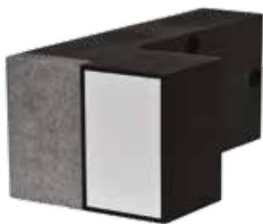
Le staffe di montaggio TRA-WIK-ALU-RL sono realizzate in schiuma poliuretana rigida imputrescibile, tinta in massa in colore nero, senza CFC, rinforzato con un inserto in acciaio con iniezione di schiuma per garantire un avvitamento aderente alla base, una piastra di alluminio per l'avvitamento del componente, e una piastra compatta (HPL), che assicura una distribuzione ottimale della pressione sulla superficie dell'elemento.
