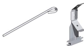
(2) Pendinatura sui travetti ogni 600 mm con lunghezza di 200 mm realizzata mediante tondino ad occhiello dritto in acciaio  $\varnothing$  4 mm e relativo gancio con molla per montanti C 27/48/27.
