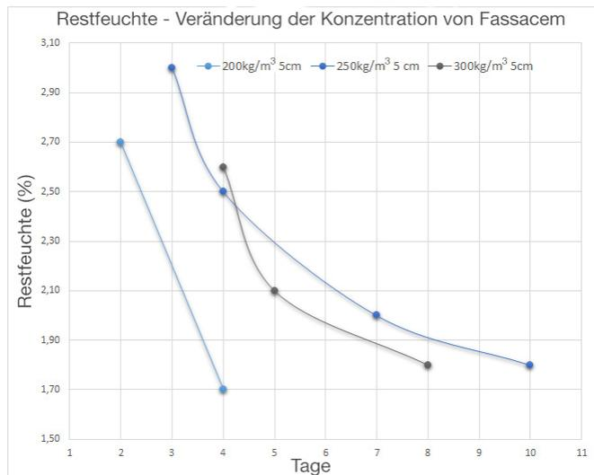
Die Probestücke zur Ermittlung der Trocknungszeiten werden unter Laborbedingungen bei +23° C und 50% R.F. angefertigt und gereift.
