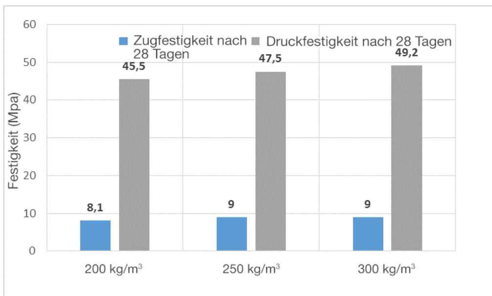
Die Probestücke betreffend die mechanischen Festigkeiten werden unter Laborbedingungen angefertigt; hierbei wird trockenes und einheitlich sortiertes Füllmaterial zu 0-8 mm verwendet und ein entsprechendes Verfahren in Übereinstimmung mit der diesbezüglichen Bezugsvorschrift (EN 13892-1) angewandt.
