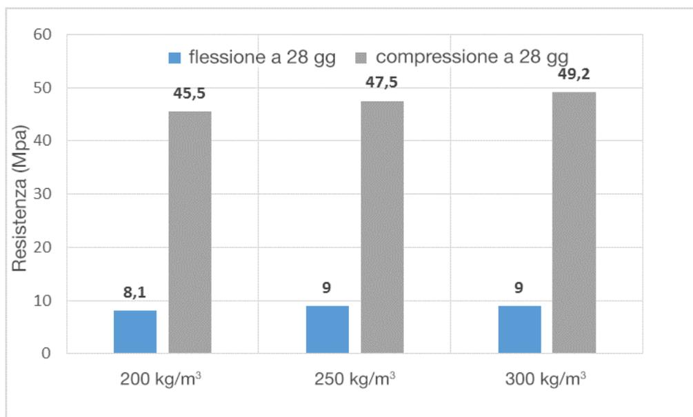
I provini per le resistenze meccaniche sono preparati in condizioni di laboratorio utilizzando inerte asciutto ed assortito 0-8mm e seguendo un'apposita procedura in accordo con la normativa di riferimento (EN 13892-1).
