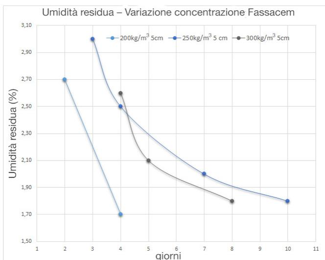
I provini per la determinazione dei tempi di essiccazione sono preparati e maturati in condizioni di laboratorio a +23°C e U.R. 50%
