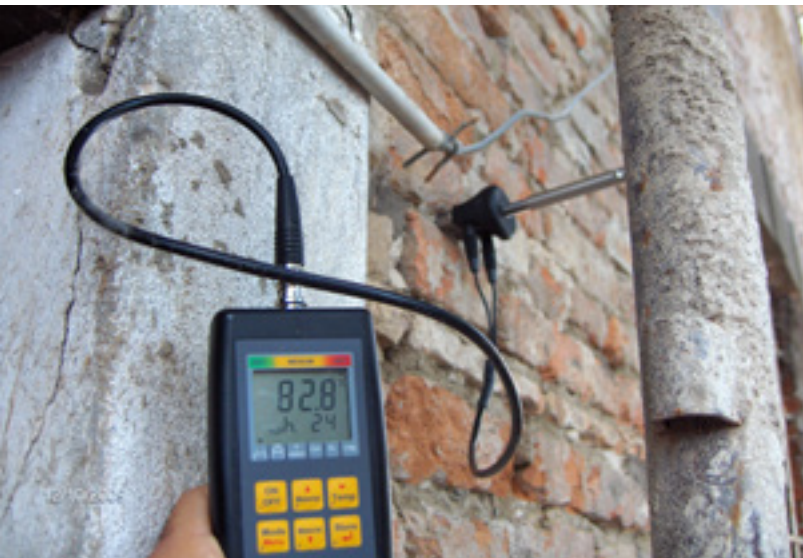
Sopra: rilevamento del livello di umidità con igrometro, sotto: applicazione di INTONACO MACROPOROSO 717
